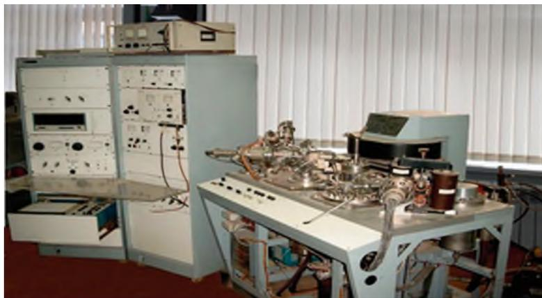
Масс-спектрометр МИ-1201В, модернизированный для изучения поверхностной ионизации
