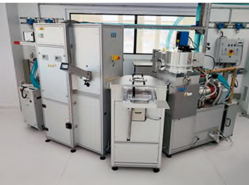
Ростовая установка – кластер атомно слоевого, химического и плазмо-химического осаждения (PEALD, PECVD) с вакуумным загрузочным шлюзом
